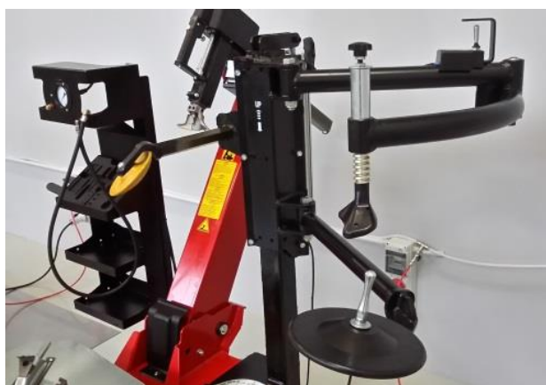
Pomocné rameno PLUS se spodním tlačným talířem a oběžným ramenem
