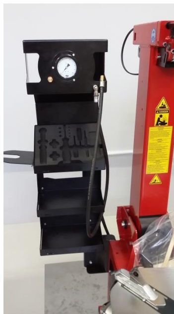
Odkládací police po levé straně sloupu, manometr, pedálové huštění
